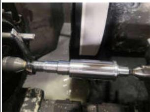
改善前:电驱动轴研磨和数控磨时,需要上螺帽进行固定,原先需要进行的流程为:上螺帽→研磨→下螺帽→再上螺帽→数控磨→下螺帽,操作繁琐影响效率。
