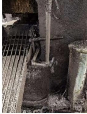
**改善后:**将硬管改为软管, 拆模架时只需拆软管一个接头, 节省作业时间。
