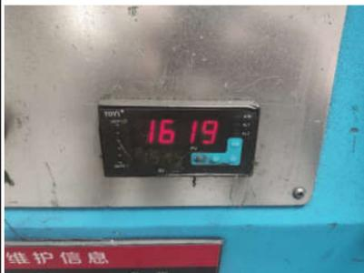
改善前:中频炉计数器只能计算出炉总数量,对于合格料、低温料、高温料的数量无法统计。
