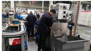
**改善结论:** 按上料节拍 1.5 计算, 每班可有效减少 30 分钟时间, 小巨人操作工可以利用这个时间进行外观检验, 提升产品质量; 钻床与精车配合作业, 可以错开休息实行轮休, 减少时间浪费 30 分钟, 产能提升 6% 左右。
