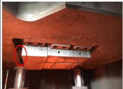
改善前:定位块在使用过程中受挤压导致变形,由于受力不均匀,前后端变形量不一,陷到模架内,造成拆卸困难。
